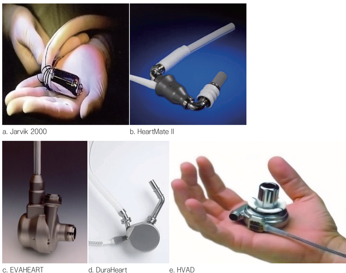
図2 日本で臨床使用されている定常流植込型補助人工心臓（臨床治験中のデバイスを含む）
